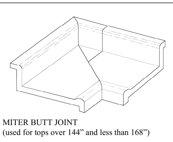
MITER BUTT JOINT
